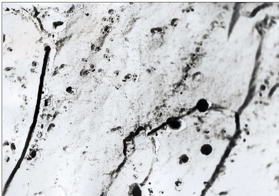
Obr. 9: Mikrostruktura pásma přehřátí TOO u vzorku 1.2.5., extrakční uhlíková replika, zvětšení 20 000x
