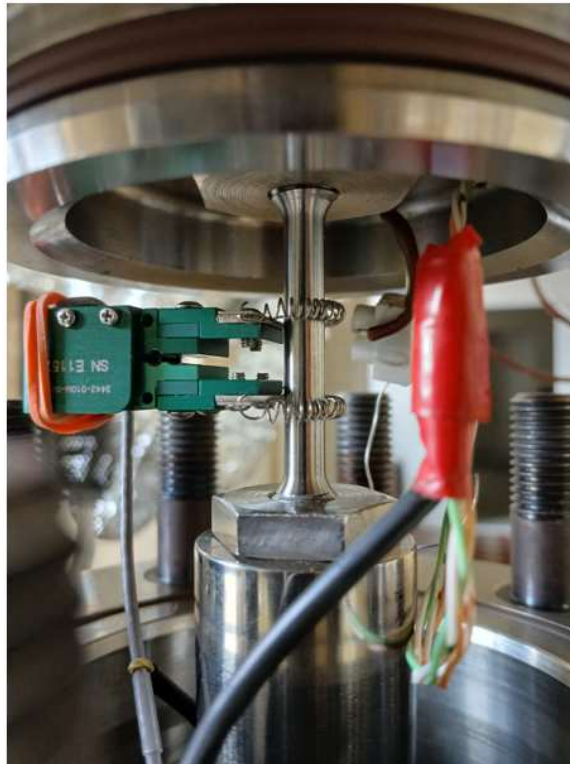
Obr. 2 Těleso připravené pro SSRT ve vodíku
